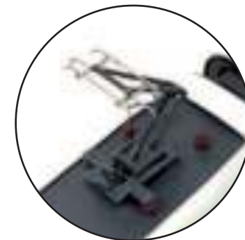
Feine Stromabnehmer, größtenteils aus Metall gefertigt
