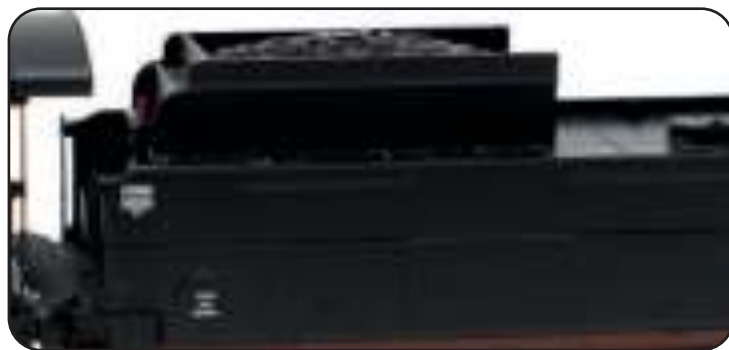
Tender con sopralzo carboniera e chiodature aggiuntive
