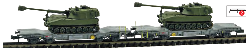
94405 Zwei Panzertransportwagen Typ Slmmps, beladen mit 2 M109 Panzerhaubitzen
