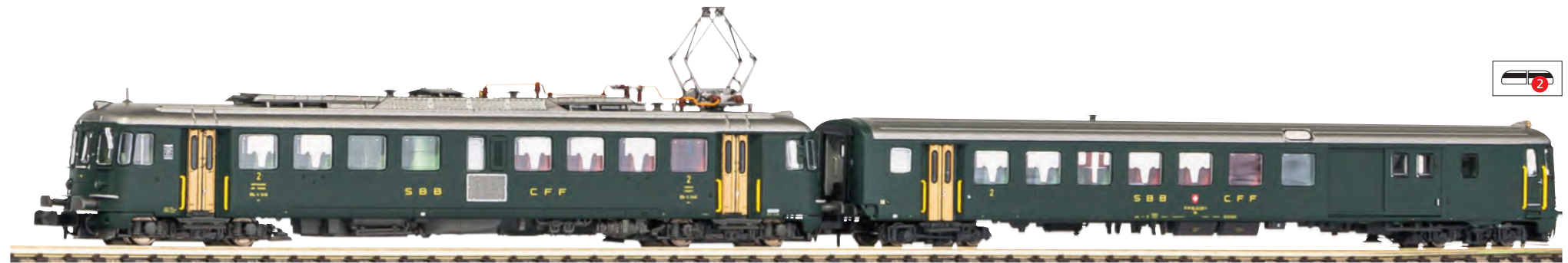
Elektrotriebwagen RBe 4/4 und Bt Steuerwagen grün mit alter Schrift SBB Ep. IV
