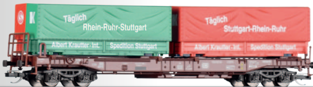
Taschenwagen Sdkms 707 der DB, beladen mit Wechselpritschen „Krautter & Simon“ Pocket wagon Sdkms 707 of the DB with load
