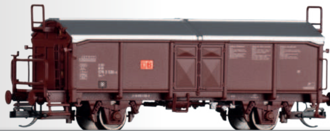
Schiebedachwagen Tms 851 der DB AG Sliding roof car Tms 851 of the DB AG
