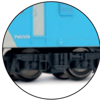
Bogies de alta velocidad aptos para 160km/h
