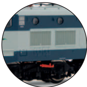
Ambientazione anni '90 con smorzatori, senza condizionatori
