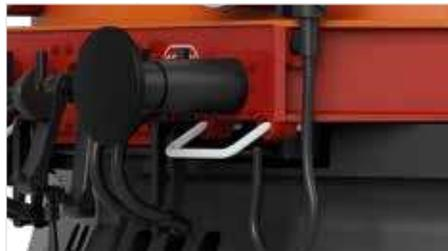
Pufferbohle mit freistehenden Griffstangen und Heizkabel
