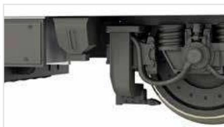
Verstärkte Ausführung der Sandfallrohre
