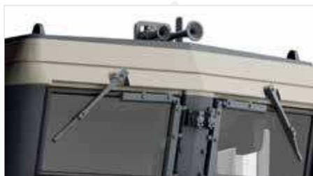
Separat angesetzte Scheibenwischer und Steckdosen
