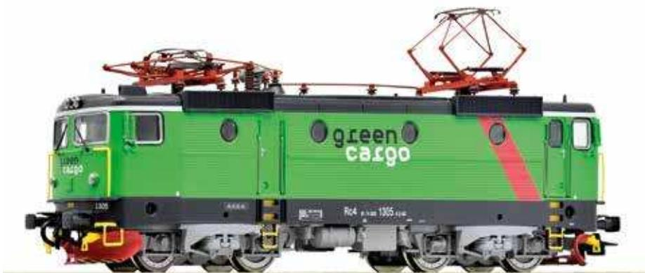
Mit den Lokomotiven der sogenannten Rc-Familie schafften die Schwedischen Staatsbahnen (SJ) vom Hersteller ASEA die ersten thyristorgesteuerten Elektrolokomotiven Schwedens an. Insgesamt liefen 360 Rc-Lokomotiven im ASEA Werk in Stockholm vom Band. Bei der Aufteilung der Schwedischen Staatsbahn in verschiedene Geschäftsbereiche zum 1. Januar 2001 kamen alle noch vorhandenen Rc4 zu Green Cargo und werden nur noch im Güterverkehr eingesetzt.
